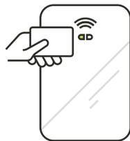
6. Die grüne LED am RFID-Modul beginnt zu blinken, während die Karte geprüft wird.
